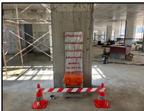
รูปที่ 3.4.4-1 การตรวจวัดความสั่นสะเทือน บริเวณพื้นที่โครงการ (ระยะฐานราก)
