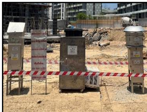
รูปที่ 3.4.1-2 การตรวจวัดคุณภาพอากาศในบรรยากาศโดยทั่วไป บริเวณพื้นที่โครงการ (ระยะฐานราก)
