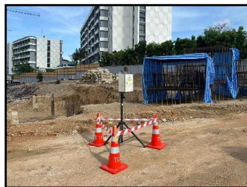
รูปที่ 3.4.3-2 การตรวจวัดคุณภาพเสียงรบกวน บริเวณพื้นที่โครงการ (ระยะก่อสร้าง)
