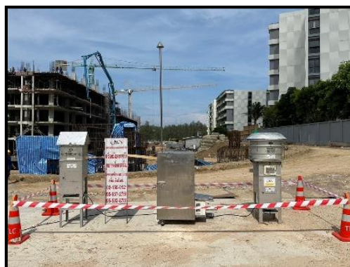
รูปที่ 3.4.1-3 การตรวจวัดคุณภาพอากาศในบรรยากาศโดยทั่วไป บริเวณพื้นที่โครงการ (ระยะก่อสร้าง)
